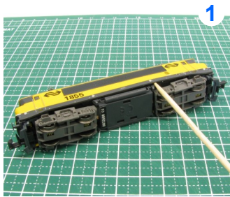
Het openen van de kap met behulp van twee satéprikkers.
